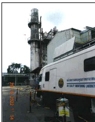
รูปที่ 3.2 การเก็บตัวอย่างคุณภาพอากาศจากแหล่งกำเนิด บริเวณปล่อง HRSG#2
