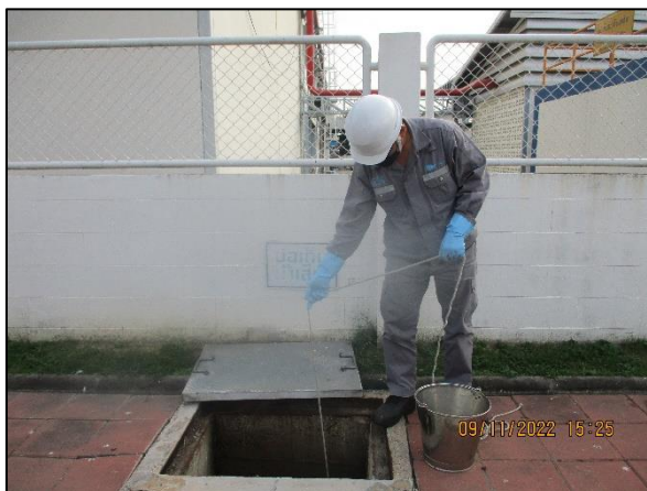
รูปที่ 3.8 การเก็บตัวอย่างน้ำ บริเวณจุดปล่อยน้ำทิ้งจุดที่ 1 จากโครงการเข้าสู่ระบบรวบรวมน้ำเสียของสวนอุตสาหกรรมเครือสหพัฒน์-ศรีราชา
